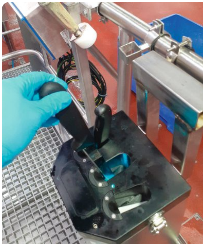
Die neue Desinfektionsanlage ist DVG-zertifiziert und kann drei Messer in einem Arbeitsgang entkeimen. Foto: Sterilsystems
